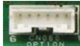
Zur Bereitstellung von Signalausgängen ist für den Anschluss an den Steckanschluss OPTION ein Stecker mit Litzen lieferbar (PAW-OCT).
