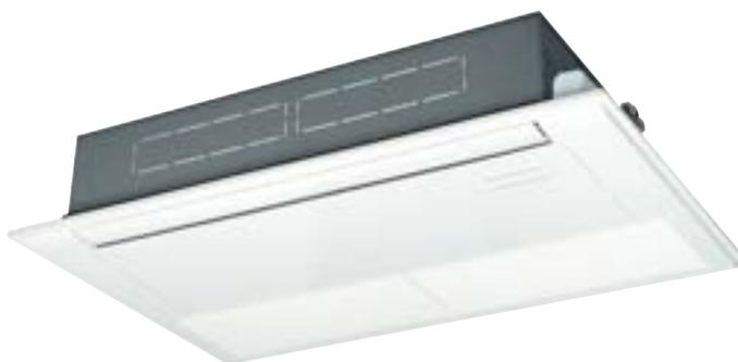
Mit ihrer äußerst geringen Bauhöhe ist die Einweg-Kassette MD1 für den Einbau in sehr engen Zwischendecken geeignet, während die leisen, aber leistungsstarken Ventilatoren Wurfweiten von bis zu 4,2 m aufweisen.
